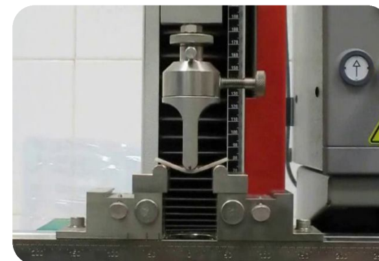
Měření mechanických vlastností vzorku paroží jelena – výzkum Dr. Ceacera.
